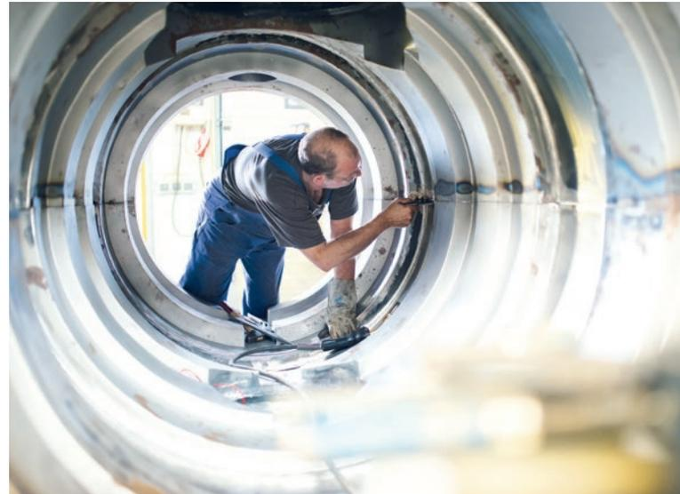
Für große Wassertanks kommen Formen aus Stahlblech zum Einsatz. Stahl ist allerdings als Formmaterial inzwischen rückläufig. Die meisten Formen werden heute aus Aluminium gefertigt.
